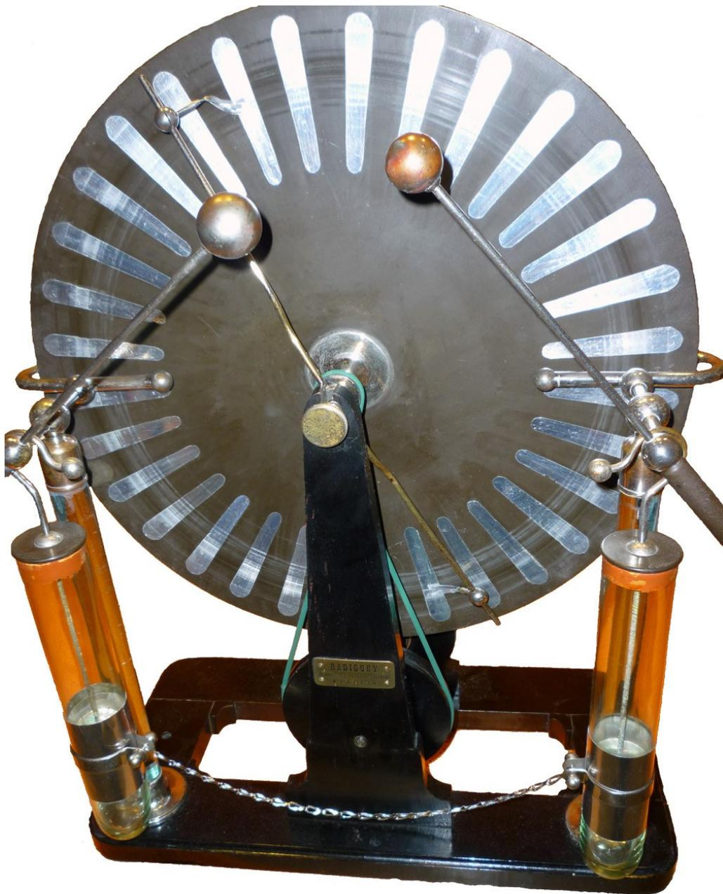
Die Influenzmaschinen oder Wimshurstmaschinen, benannt nach dem britischen Ingenieur James Wimshurst (1832-1903), sind ein Relikt aus den Anfängen der Elektrotechnik. Ihre Weiterentwicklung ist mit der Einführung der magnetischen Maschinen praktisch stehen geblieben. Heute werden sie nur noch zur Demonstration der Elektrostatik verwendet.
